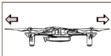
Когда вы двигаете ручку тангажа, квадрокоптер будет двигаться вперед либо назад относительно поперечной оси.
