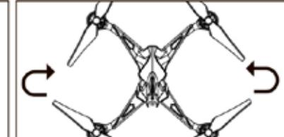
Когда вы двигаете ручку рыскания в разные стороны, нос модели будет вращаться вокруг вертикальной оси.
