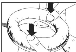
Поставьте на место новую подушку амбушюра нажав на неё до щелчка фиксаторов.
