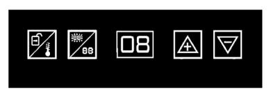
Холодильный шкаф для вина оснащен автоматической блокировкой панели управления, которая будет включаться после последнего касания кнопки.
